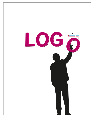
Applicare le lettere direttamente alla parete allacciando i fili provenienti dalle lettere ai fili uscenti dai tubi sottotraccia.
