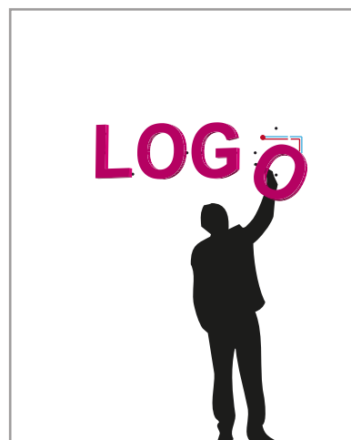
Applicare le lettere direttamente alla parete allacciando i fili provenienti dalle lettere ai fili uscenti dai tubi sottotraccia.
